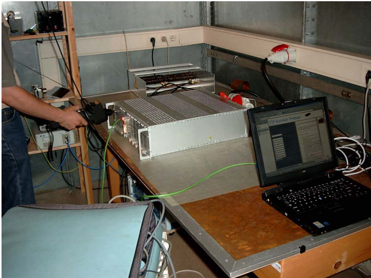
Bild: Prototyp TTF Körrekturnetzgerät bei der EMV-Prüfung
